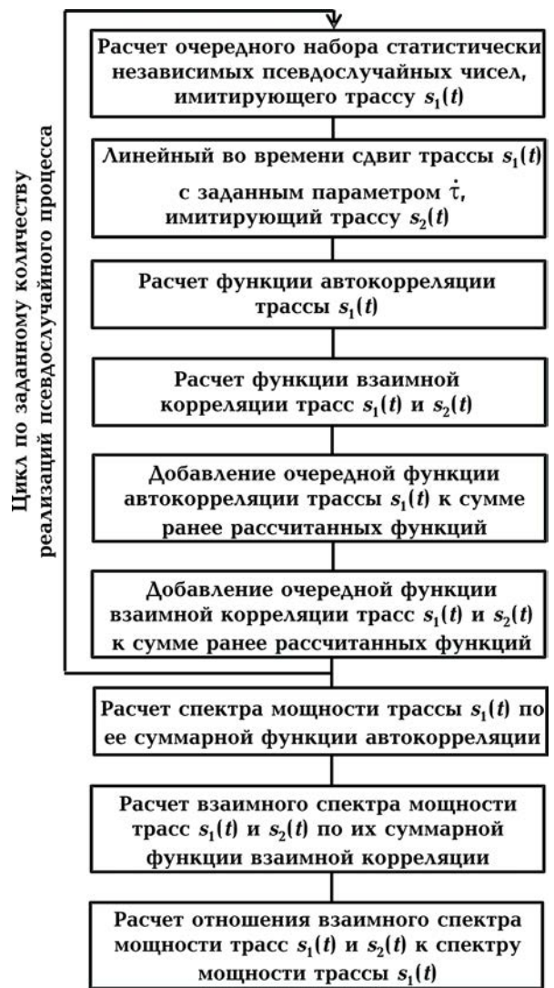
Рис. 1. Блок-схема модельного эксперимента, предназначенного показать зависимость отношения взаимного спектра мощности трасс s_1(t) и s_2(t) к спектру мощности трассы s_1(t) от количества используемых реализаций случайного процесса.
