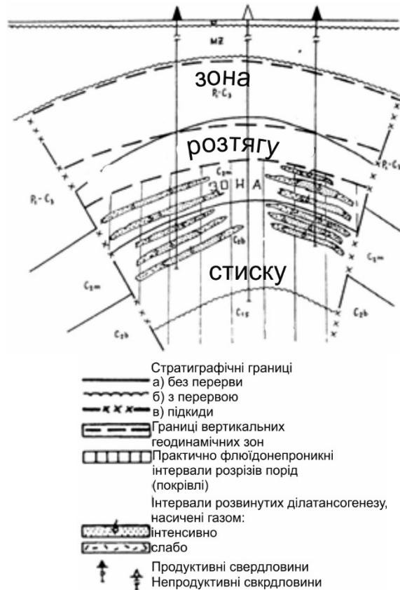
Рис. 1. Узагальнена схема геодинамічних зон у вертикальному розрізі структури субгоризонтального стиснення типу горст-антикліналі
