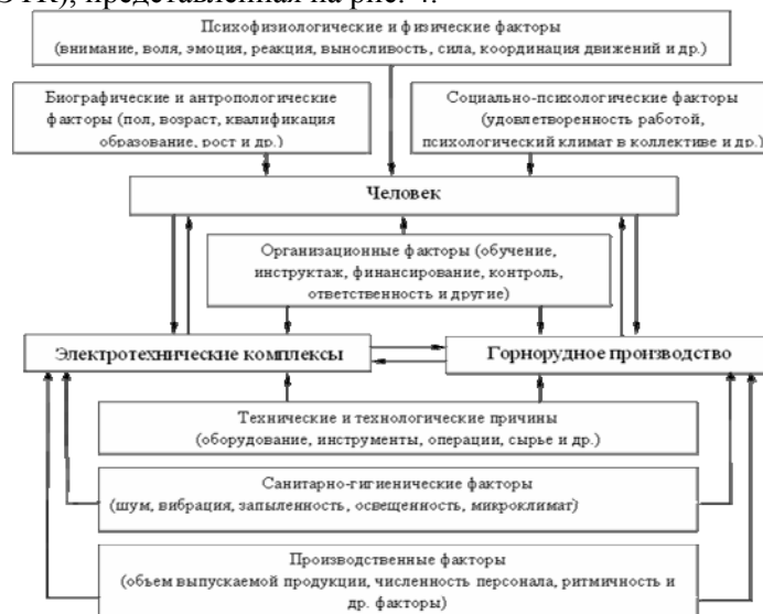
Рис. 4. Структура возникновения травмоопасных факторов в системе «человек - горнорудное производство - электротехнические комплексы»
