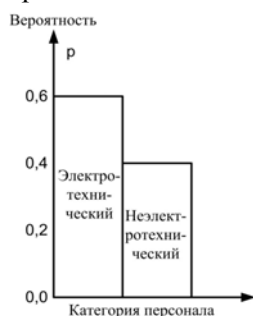
Рис. 2. Гистограмма распределения вероятностей травмирования электрическим током электротехнического и неэлектротехнического персонала железорудных производств
