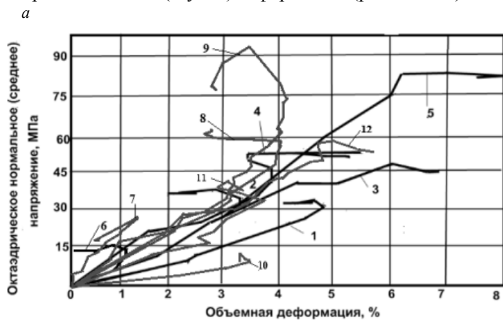
Рис. 1. Залежність «октаедричне нормальне напруження (кульовий тензор) – об'ємна деформація» (а) та «октаедричне дотичне напруження-октаедрична дотична деформація» (б) для аргіліту (1-6), пісковиків (7-9) і вугілля (10-12) при різних видах напруженого стану
