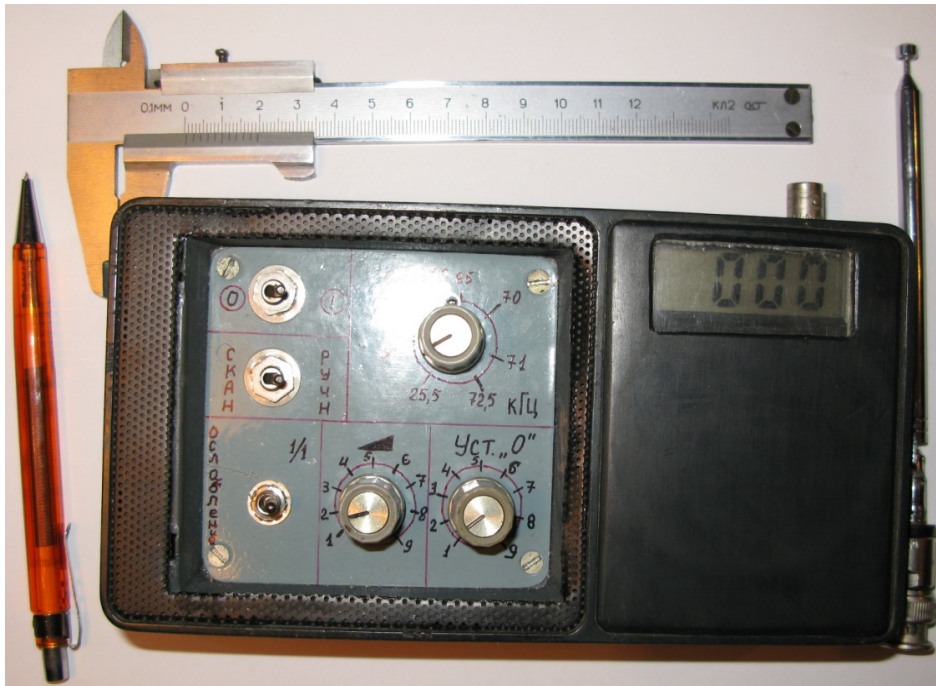
Рис. 1. Внешний вид индикатора напряженности электромагнитного поля при отключенной антенне.
