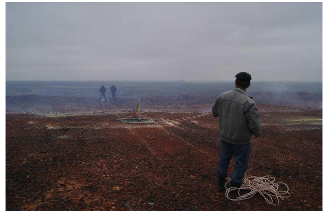
Рисунок 3 – Обследования горных отвалов закрытых шахт георадиолокационным методом дистанционного зондирования
