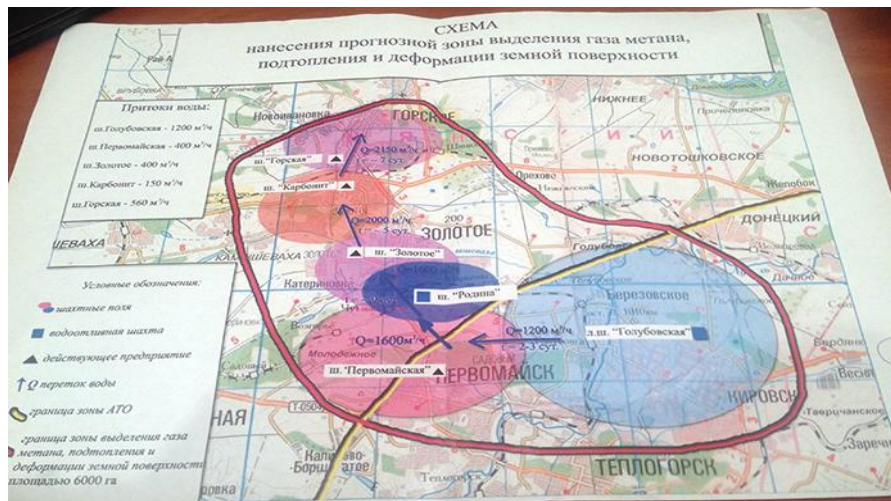
Рисунок 4 – Схема нанесения прогнозной зоны выделения газа метана, подтопления и деформации земной поверхности
