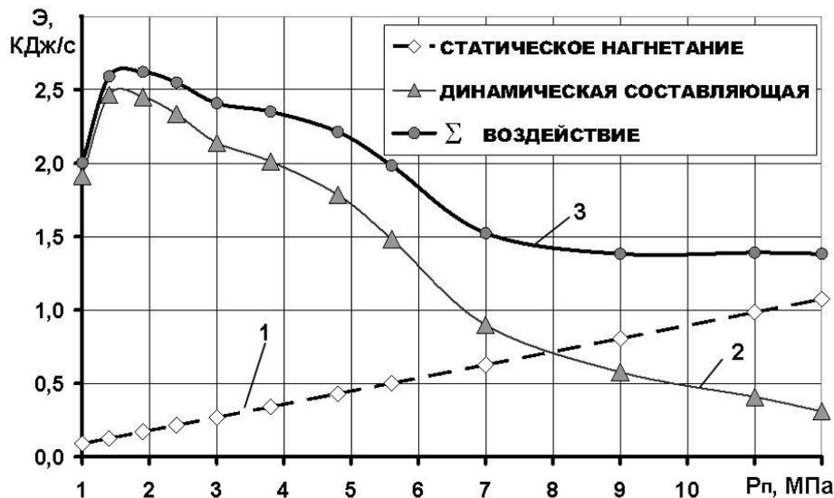
Рисунок 2 – Расчетные зависимости потока энергии  $\mathcal{E}$  от давления подпора  $P_p$  при значениях расхода  $Q=55$  л/мин и давлении нагнетания  $P_n=20$  МПа
