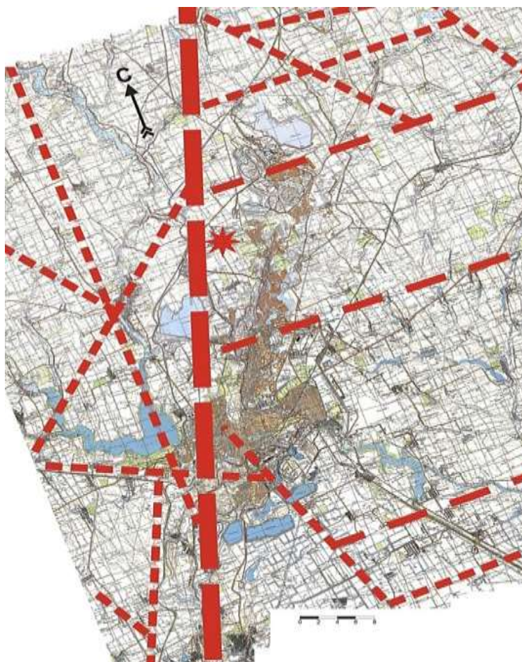
Рисунок 4 - Криворожско – Кременчугский глубинный разлом, геологические нарушения второго рода на территории горных разработок г. Кривой Рог (по Феськовой Л.В. [1])
