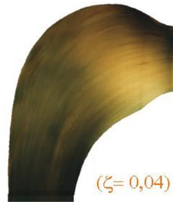
Рисунок 4 – Проектування оптимального відводу на 90^\circ : а – «чорний ящик»; б – «СП-відвід» \mu = 0,98
