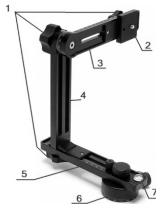
Рисунок 2 – Загальна конструкція панорамної головки: 1 – фіксуючі гвинти; 2 – платформа для встановлення камери; 3 – верхня направляюча; 4 – вертикальна стійка; 5 – нижня направляюча; 6 – ротатор; 7 – бульбашковий рівень
