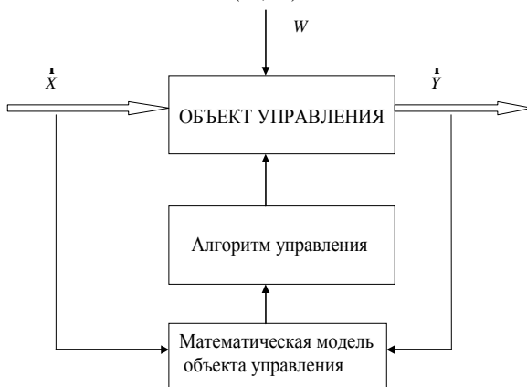
Рис. 1. Функциональная схема системы управления сложным объектом
