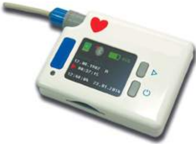
Рис. 2. Внешний вид автономного усилителя биопотенциалов с записью данных на SDHC флеш-карту и беспроводной передачей данных по Bluetooth.
