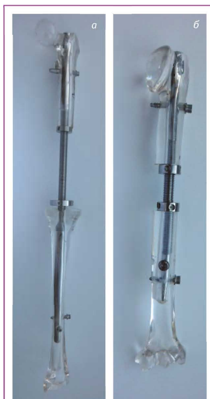
Рис. 3. Специальные устройства для фиксации фрагментов кости: а — макет имплантации фиксатора по типу бедренно-большеберцового артродеза; б — макет имплантации фиксатора в плечевую кость
