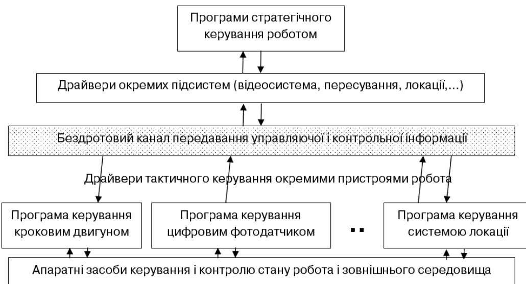
Рис. 1. Ієрархія функцій і програмних засобів системи керування роботом
