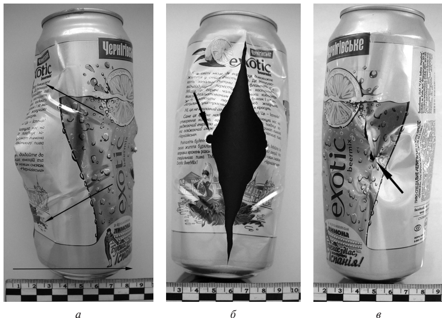
Рис. 3. Постріл із гвинтівки Діана-350; відстань 50 см. Деформація корпусу банки (а) в бік, протилежний напрямку польоту снаряда (показано стрілками). Розриви і деформація металу в ділянках вхідного (б) і вихідного (в) ушкоджень (показано стрілками)
