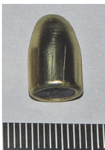
Рис. 29. Стан кулі типу «FMJ» патрона виробництва ЧП НПФ «ТАХО» після влучення в імітатор біологічних тканин
