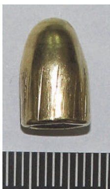
Рис. 8. Стан кулі типу «FMJ» патрона виробництва ЧП НПФ «ТАХО» після влучення в імітатор біологічних тканин
