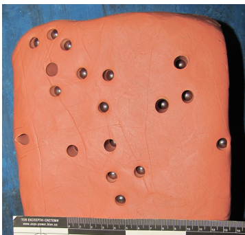
Рис. 12. Характер ураження блоку балістичного пластиліну при стрільбі стальними шариками діаметром 10,3 мм
