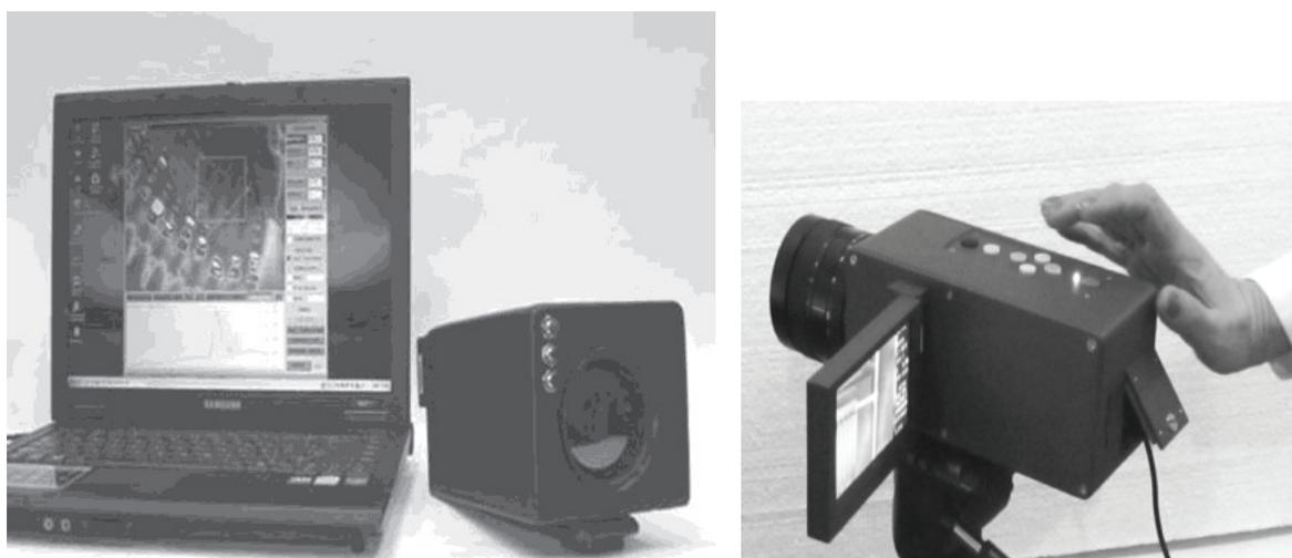
**Рис. 3.** Термографы на основе *неохлаждаемых* болометрических матриц большого формата. Слева направо: 2009 г. - термограф на основе матрицы форматом 320x240 элементов; 2012 г. - термограф на основе матрице форматом 384x288 элементов со встроенным экраном.
