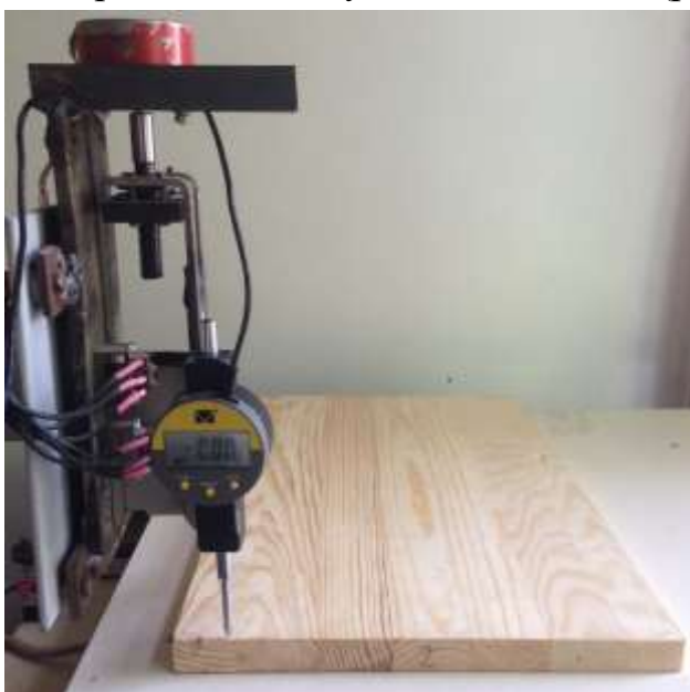
Рис. 2. Експериментальна установка з ЧПУ для визначення формостійкості
