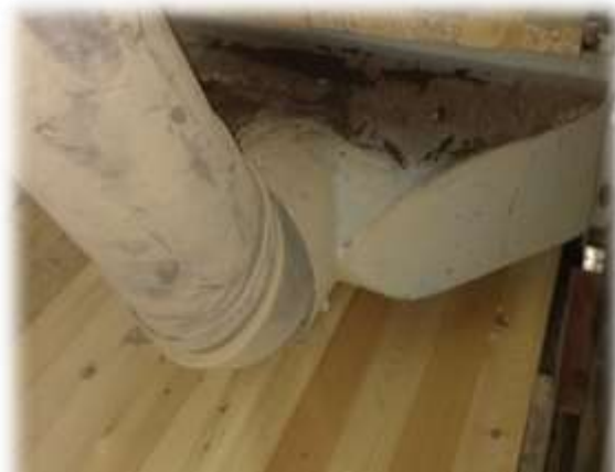
Рис. 6. Виконання операції стругання склеєних щитів за товщиною
