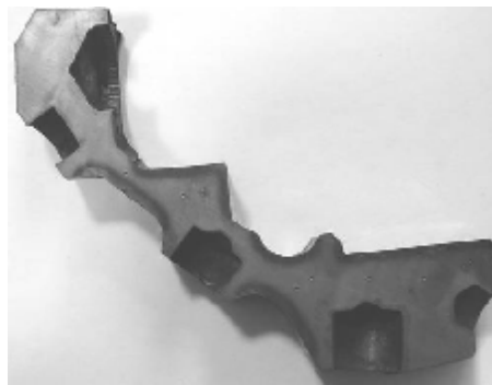
Рис. 2. Темплет виготовлений з шарошки долота
