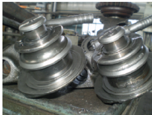
Рис.1. Порівняння експериментальної (ліворуч) та серійної (праворуч) лап секцій доліт 244,5ОК-ПГВ, що відпрацьовали в стендових умовах 65 год
