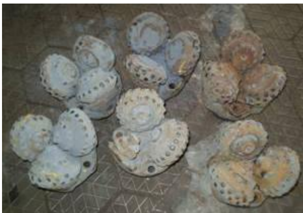
Рис. 1. Загальний вигляд руйнувань шарошок партії тришарошкових бурових доліт
