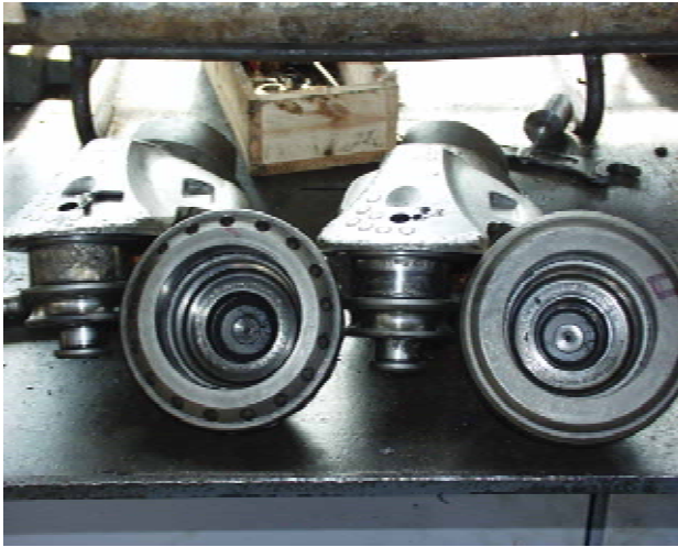
Рис. 4. Загальний вигляд розібраних комплектів доліт 244,5 ОК-ПГВ Д26, відпрацьованих у стендових умовах а – серійний комплект (лапа зі сталі 19ХГНМА-В після ХТО), б – експериментальний комплект (лапа зі сталі 21ХГНМА-В після ХТО і криогенної обробки)
