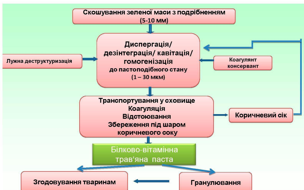
Рисунок 3 – Технологічна схема виробництва білково-вітамінної трав'яної пасти
