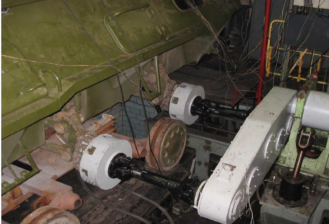
Рис. 4. Подключение суммирующего редуктора к ступицам колёс задних мостов БТР с помощью карданных валов и переходников.
