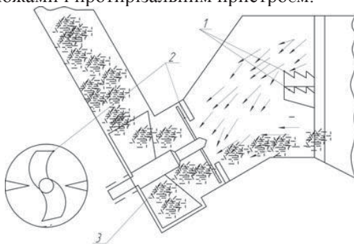
Рис. 1. Схема подрібнювача вентиляторного типу: 1- клавіші соломотряса; 2- ножі; 3-лопата
