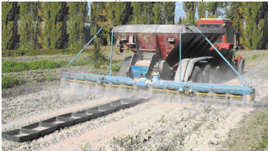
Рис. 3. Визначення якісних показників роботи машини, обладнаної шнековою розподільно-висівною системою
