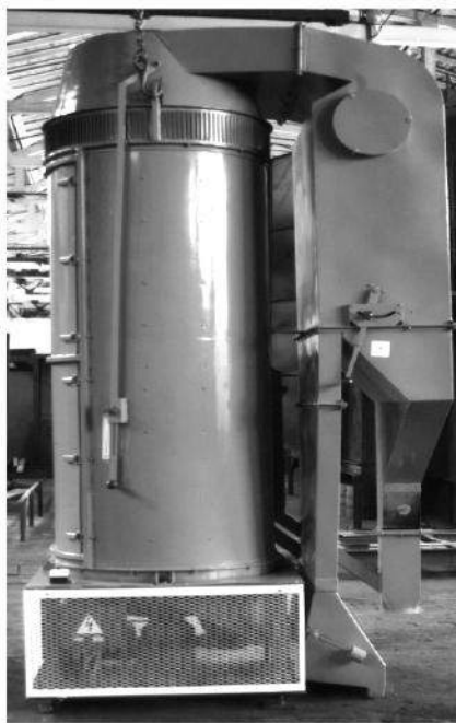
Рис. 2. Загальний вигляд експериментального зразка універсального вібровідцентрового зернового сепаратора продуктивністю 50 т/год.
