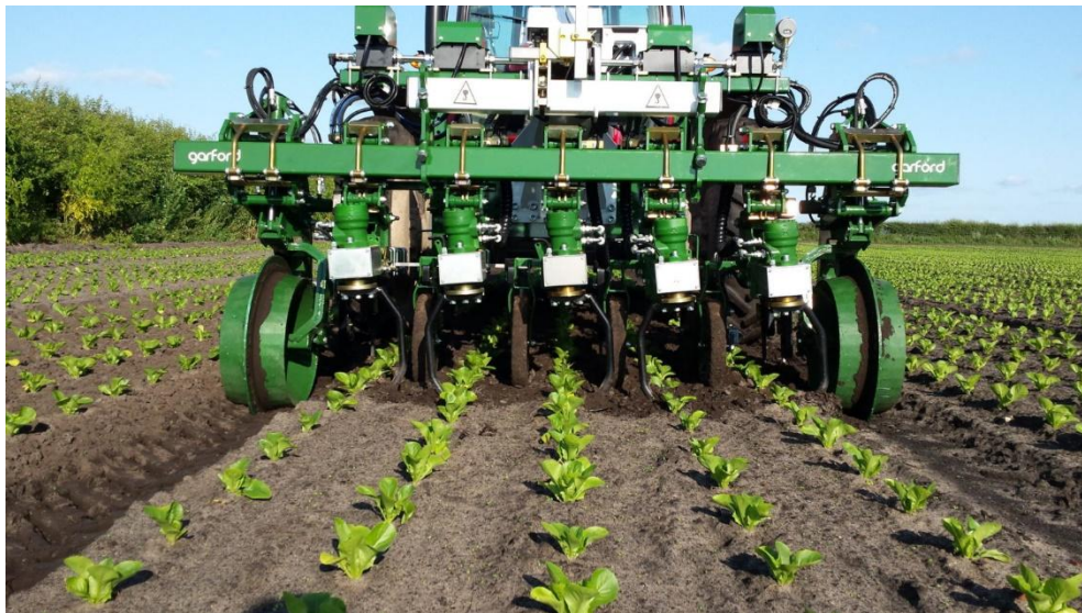
Рис. 3. Прополувальний культиватор Robocrop InRow Weeder з високоточною системою відеозору
