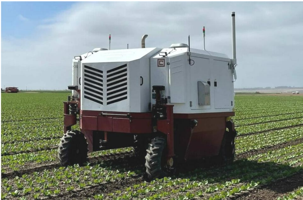
Рис. 4. Технічний засіб Autonomous LaserWeeder для знищення бур'янів лазером Fig. 4. Autonomous LaserWeeder technical tool for destroying weeds with a laser
