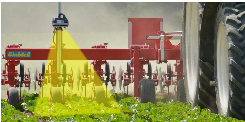
Рис. 1. Автоматична система керування на базі камер ROW-GUARD Fig. 1. Automatic control system based on ROW-GUARD cameras
