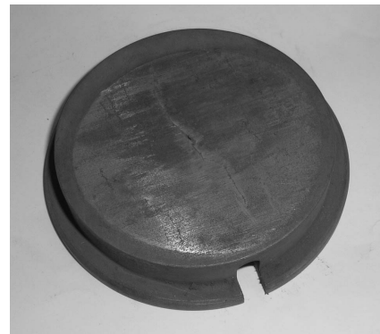
Рисунок 5 – Зразок запобіжного ковпачка давача 4201 ДСТ - 10, зношений в результаті шахтних вимірювань на п'ятидесятитонному скіповому підйомі шахти "Ювілейна" ВАТ "Суха Балка"
