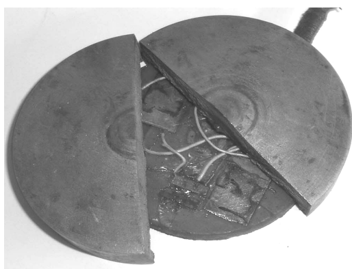
Рисунок 7 – Експериментальний зразок давача 4201 ДСТ – 10, зруйнований в результаті шахтних випробувань на шахті «Експлуатаційна» ЗЗРК
