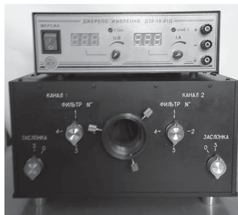
Рис. 10. Зовнішній вид стенду для формування стабільних потоків випромінювання за вимірювання енергетичних характеристик і нелінійності чутливості електронних приладів ИДНМ4.004.00.00 Fig. 10. Appearance stand to form a stable flow of radiation in measuring energy performance and sensitivity nonlinearity ИДНМ4.004.00.00 electronic devices.
