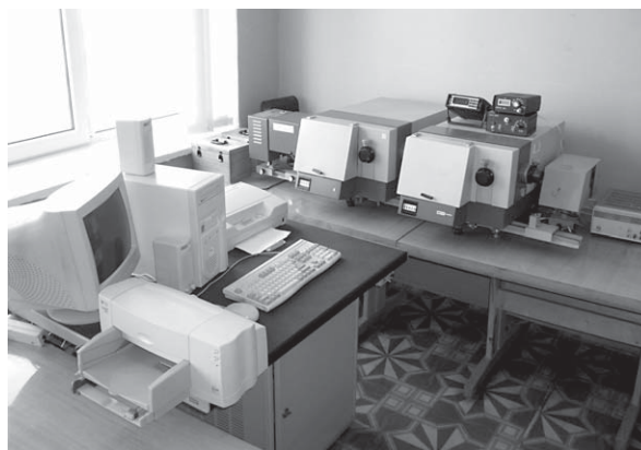
Рис. 5. Зовнішній вид установки для вимірювання спектральних характеристик чутливості електронно-оптичних приладів ИДНМ4.011.00.00 Fig. 5. Appearance setting to measure the spectral sensitivity characteristics of the electron-optical devices ИДНМ4.011.00.00.
