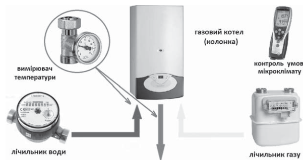
Рис. 4. Структурні елементи схеми способу експрес-контролю теплоти згоряння природного газу в споживача комунально-побутового сектору
