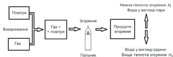
Рис. 3. Схематичне зображення процесу горіння з виділенням теплоти згоряння
