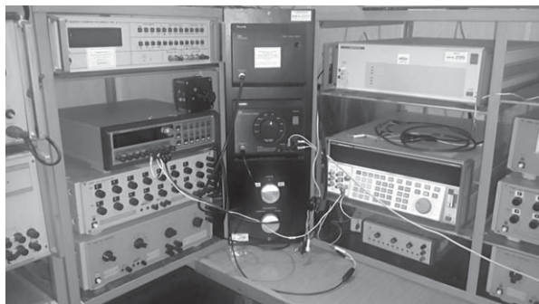
Рис. 1. Державний еталон одиниці електричної напруги від 0,1 до 1000 В змінного струму в діапазоні частот від 20 Гц до 1 МГц
