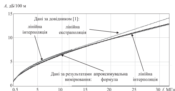
Рис. 2. Частотна залежність власного загасання за узагальненими середніми значеннями для кабеля ТППепЗ 10x2x0,4 та визначена за довідником [1] для кабеля типу ТПП з діаметром жил 0,4
