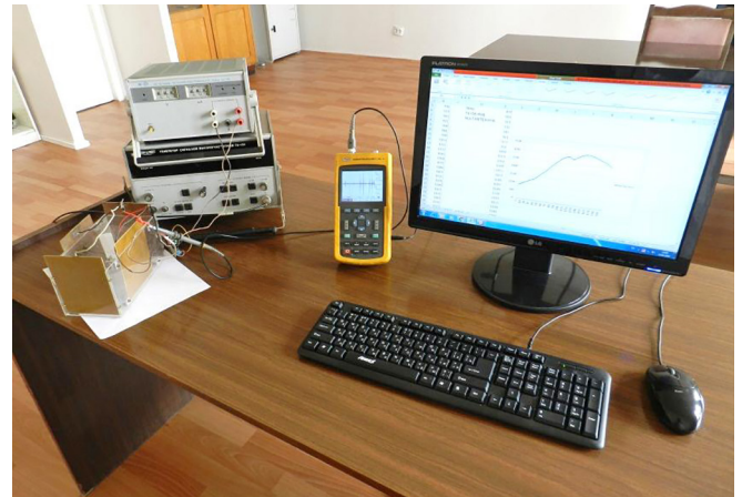
Рис. 1. Экспериментальная установка для возбуждения и управления модулированными акустическими полями
