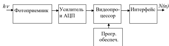
Рис. 1. Схема интеллектуальной камеры (разработка авторов)
