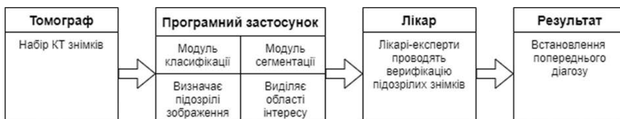
Рис. 1. Схема включення програмного застосунок в скринінг КТ знімків
