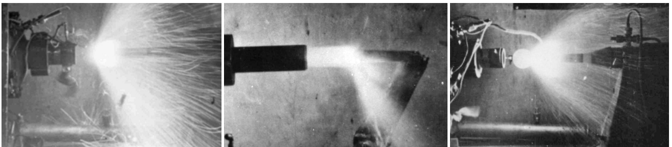
Рис. 1. Кінокадри загальної картини вимушених пожежонебезпечних руйнувань виробів на основі ущільнених нітратно-титанових сумішей в умовах зовнішніх термодій на їх поверхні (зйомка здійснювалася кінокамерою «Конвас-автомат» зі швидкістю 30 кадр/с, а нагрів виробів — кварцовими лампами типу КГМ-220-1000-1 із застосуванням керованих термодатчиків РИФ-101 для контролю температури на поверхні виробів в діапазоні 300 \dots 1900 К [3; 5; 7]:
