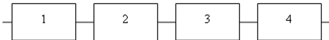
Рис. 1. Структурна схема надійності РВС: 1 — днище, 2 — покрівля, 3 — циліндрична стінка, 4 — уторний вузол
