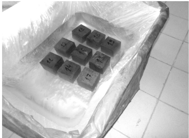
Рис. 2. Зразки бетону у ванні відтавання
