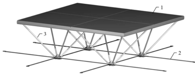
Рис. 1. Фрагмент сталезалізобетонного структурно-вантового покриття
