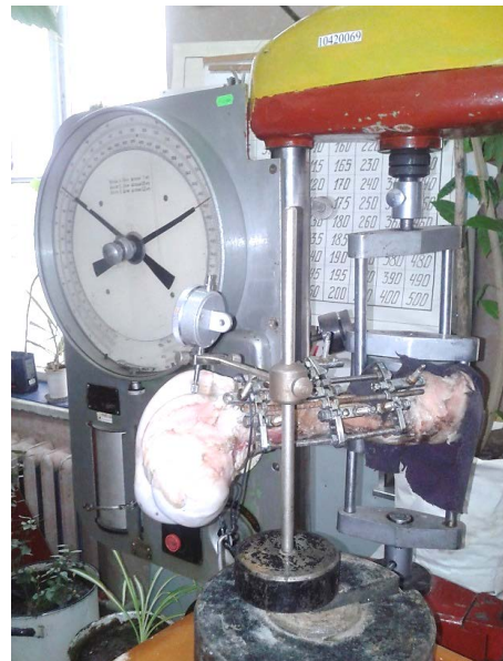
Рис. 1. Загальний вигляд установки для вимірювань із натурним зразком, синтезованим стержневим апаратом
