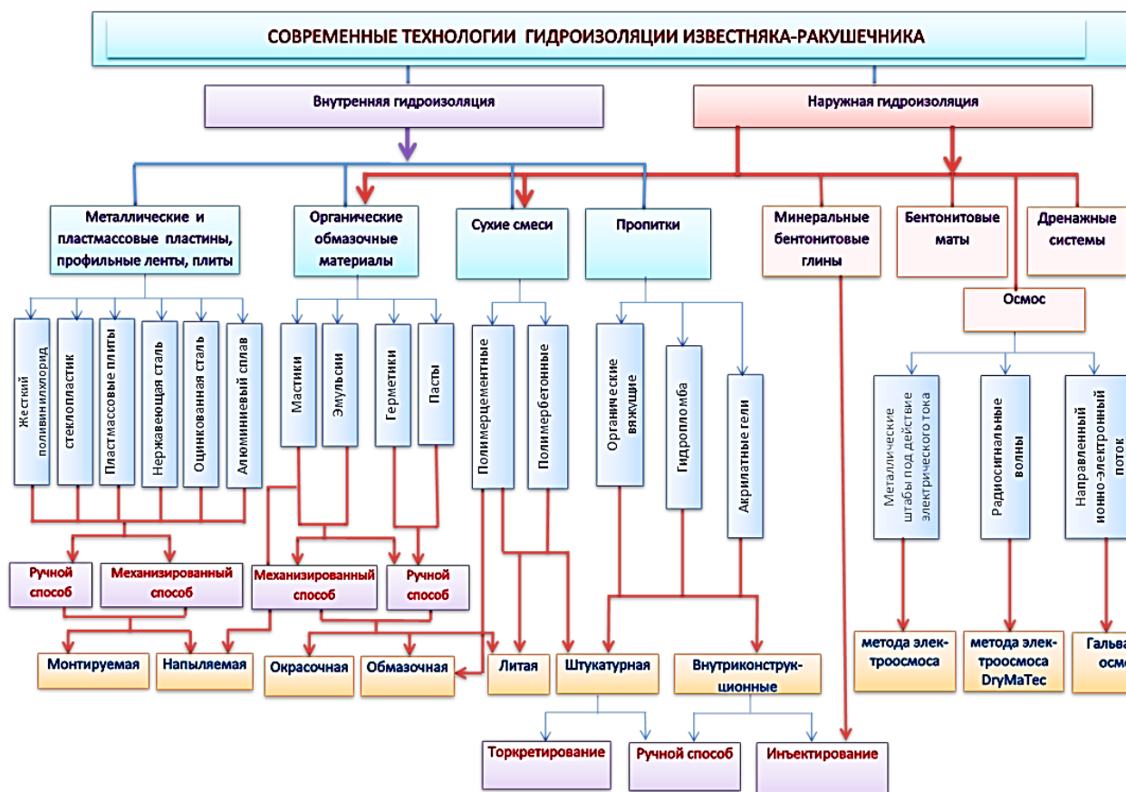
Рис. 1. Классификация способов восстановления гидроизоляции
