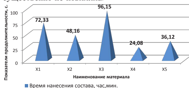
Рис. 3. Показатели продолжительности устройства гидроизоляции на сухую поверхность
