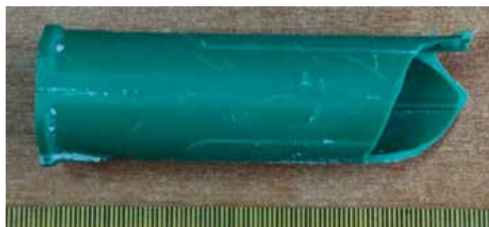
Зображення 2. Фрагмент полімерного матеріалу розмірами 26 × 90 × 2 мм, наданий на дослідження
