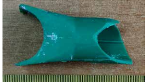
Зображення 5. Фрагмент полімерного матеріалу розмірами 66 × 25 × 2 мм, наданий на дослідження
