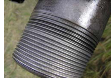
Рис. 6. Вид резьбового конца диффузионно-оцинкованной НКТ после промышленных испытаний в глубокой (3 800 м) нефтяной скважине
