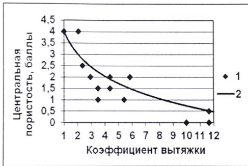
Рис. 3. Порівняння розрахункових даних з експериментальними даними [26]: 1 – експериментальні дані [28]; 2 – розрахункові дані
