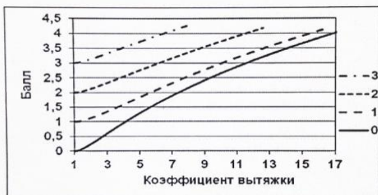
Рис. 5. Максимально допустимий бал центральної пористості та ліквіації в макроструктурі БЛЗ залежно від вимог до макроструктури готового прокату і коефіцієнта витяжки: 0, 1, 2, 3 – бал центральної пористості та підусадкової ліквіації
