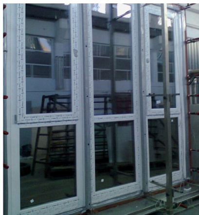
Рис. 4. Установка для випробувань огороджувальних конструкцій на повітряно-водопроникність, опір вітровому навантаженню та опір статичному навантаженню до дії на обмежувач кута відхилення ступки.
