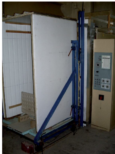
Рис. 3. Камери для проведення випробувань з визначення терміну ефективної експлуатації фасадних конструкцій та теплоізоляційних матеріалів.
