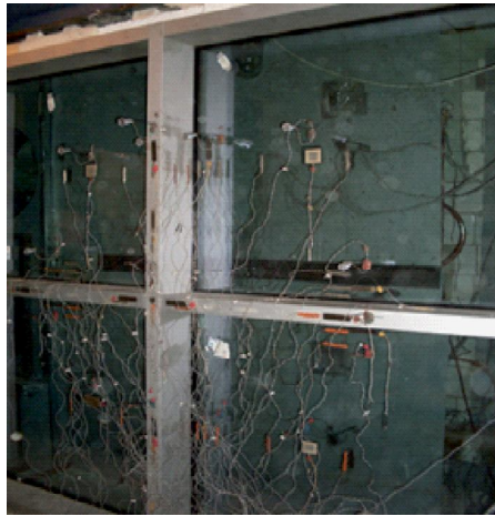
Рис. 2. Кліматична камера для проведення випробувань з визначення опору теплопередачі світлопрозорих та легких (огорожувальних) конструкцій
