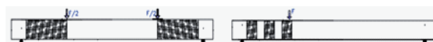
Рис. 3. Підсилення похилих перерізів балки PBO-FRCM: а – наклеюванням суцільного шару тканини підсилення; б – наклеюванням підсилення у вигляді стрічок.
