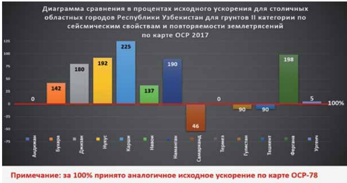
Рисунок 1 – Диаграмма сравнения в процентах исходного ускорения для столичных городов областей Республики Узбекистан для грунтов II категории по сейсмическим свойствам и повторяемости землетрясений по карте ОСР 2017
