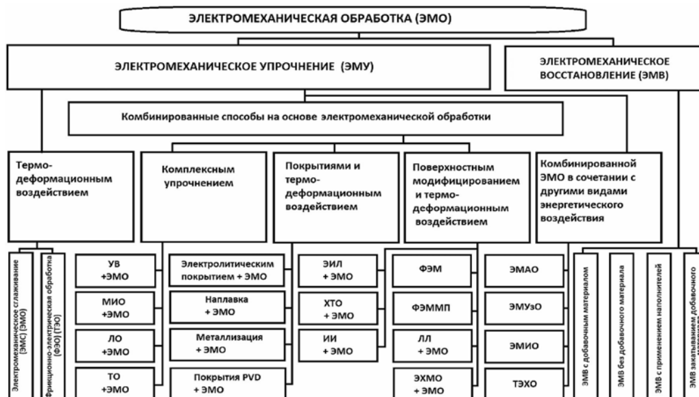
Рис. 1. Классификация методов электромеханической обработки (ЭМО) и комбинированных методов обработки на основе ЭМО
